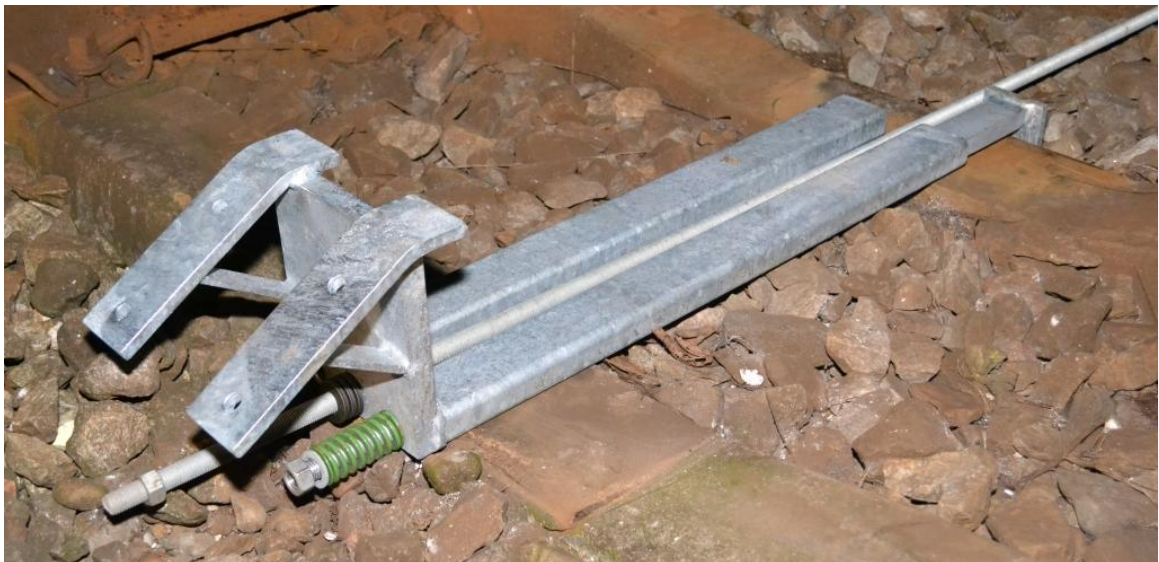
Fig. 2. Opsluithaak voor de binnenste overwegplaten met schotelveren op de trekstang en stempelveer (groen) op de veiligheidshaak
