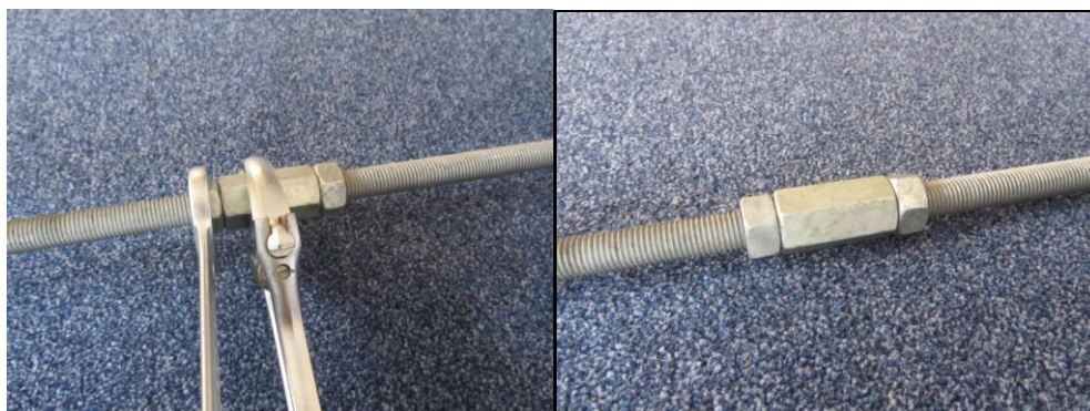
Fig. 4. Andere draadeind met contramoer in verbindingssmoer draaien en vastzetten.
