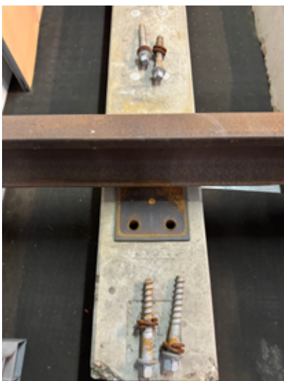
Afbeelding 8 Bevestiging van de ShimLift met bestaande bevestigingsmiddelen
