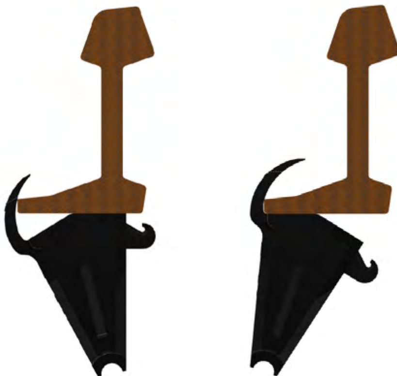
Afbeelding 2: Tong in uiterste stand rustend op het pendelblok: afliggend (links) en aanliggend (rechts)
