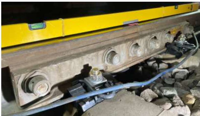
Afbeelding 23 Controle van de vlakheid van de ES-las
