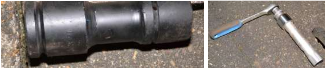
Afbeelding 18 Verlengde dop 32 en ratel met pijpsleutel 30/32 (R)
